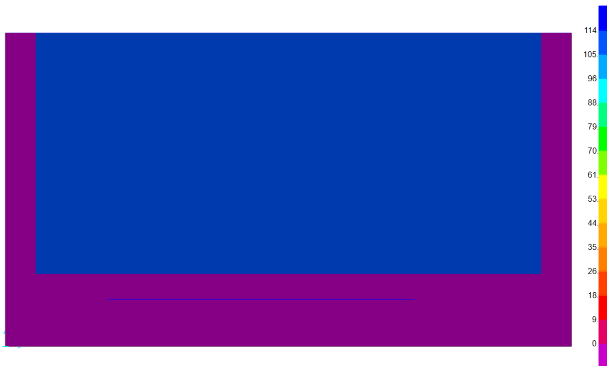
Figura 107: Applicazione componente verticale spinta della terra
